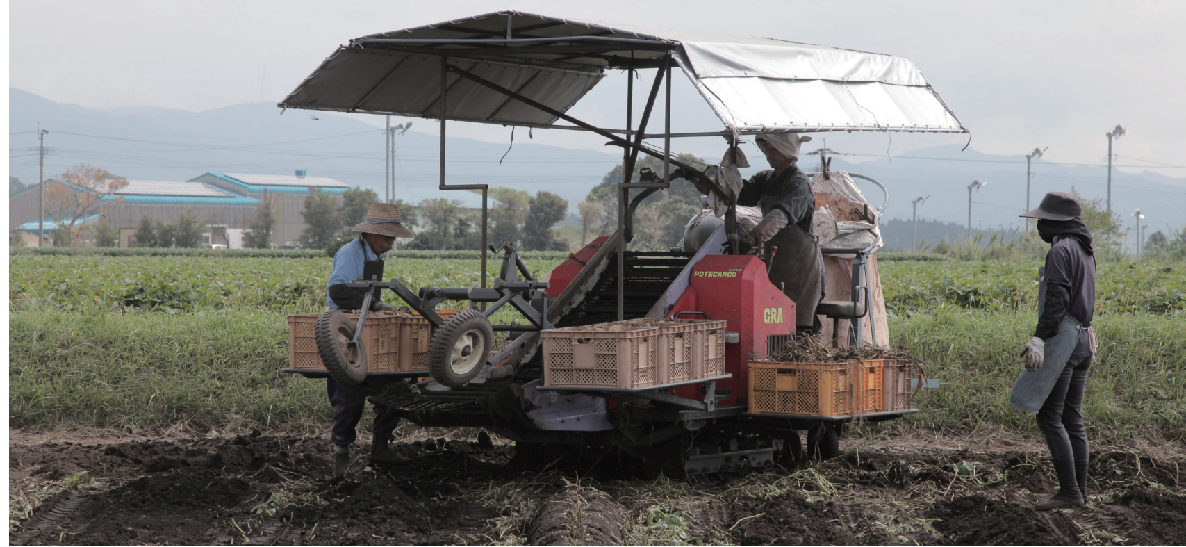
ハーベスタと呼ばれる収穫機。移動しながらサツマイモをベルトコンベアで車上まで運び上げ、石など混雑物との仕分けも乗員が行う。
